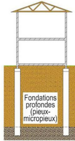
Les pieux et micropieux permettent d'atteindre des couches de sols avec de bonnes caractéristiques mécaniques et des variations hydriques faibles. De plus, cette solution reste pérenne dans le temps puisqu'elle ne demande pas d'entretien et les couches de sols sollicitées ont peu de risque d'évoluer.
