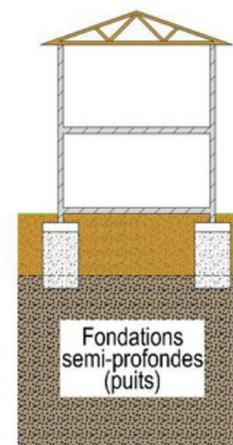
Ce système de fondation est utilisé dans les cas où les caractéristiques mécaniques du terrain ne permettent pas de supporter la charge du bâtiment, il est alors nécessaire d'approfondir les fondations jusqu'à atteindre une couche de sol ayant des caractéristiques suffisantes.
